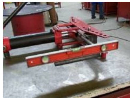
3 assurer la planéité de l'ensemble par l'un des trois moyens de contrôle appropriés par mesure à la base du tube
