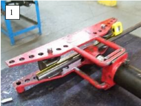
1 Mise en position du tube suivant la cote calculée
